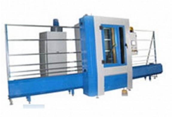
Рисунок 8- Kufra 2 1300 автоматическая установка для пескоструйной обработки стекла SCV system
