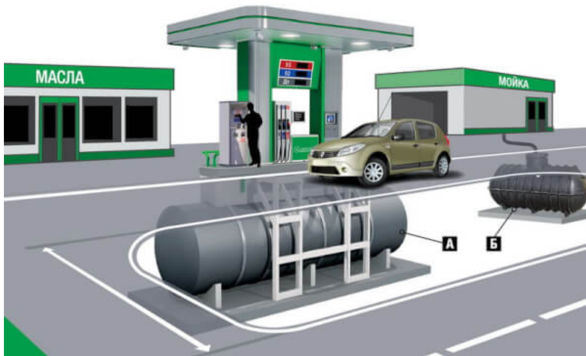
Рис. 1 – Подземный резервуар для топлива
