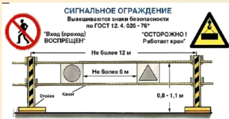
Рисунок 2.4 — Требования к сигнальным ограждениям
