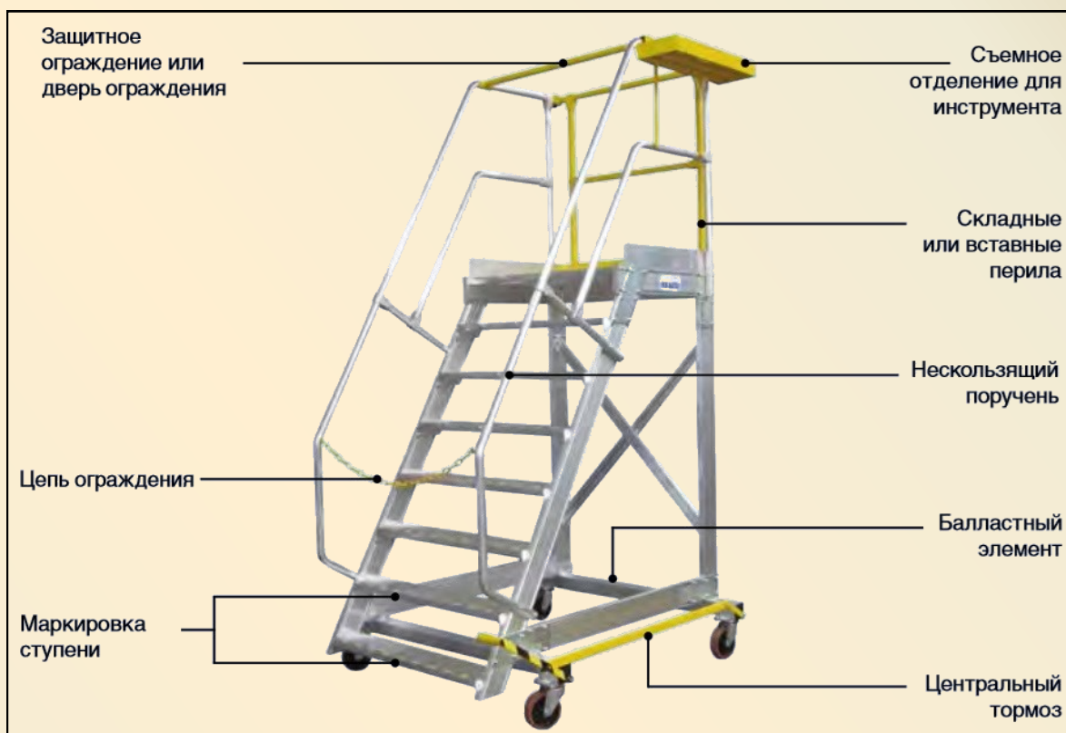
Рисунок 2.8 — Конструкция площадки для работ на высоте
