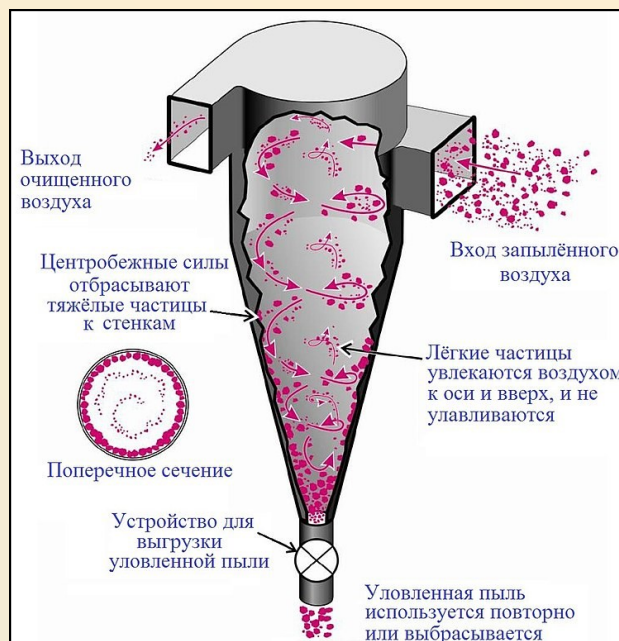
Рисунок 2.6 — Конструкция пылеулавливающего циклона
