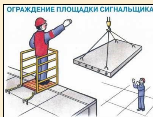
Рисунок 2.10 – Пример защитного ограждения
