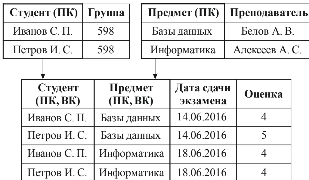
Рис. 4.6 – Схема БД «Успеваемость» в 2НФ
