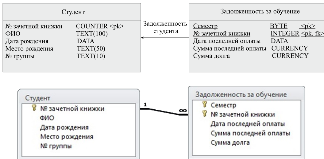
Рис. 4.17 – Пример сгенерированной физической ER-модели и схемы БД
