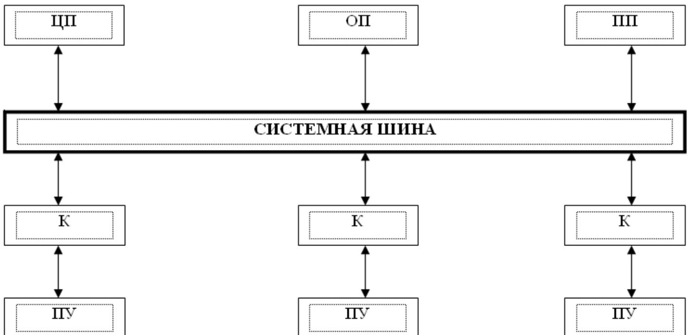
Шинная структура ПК (ЦП - центральный процессор, ОП - оперативная память, ПП - постоянная память, К - контроллер, ПУ - периферийное устройство).
