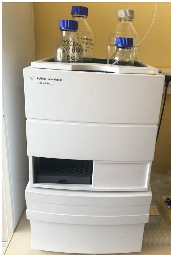
Рис.6. Высокоэффективная жидкостная хроматография
