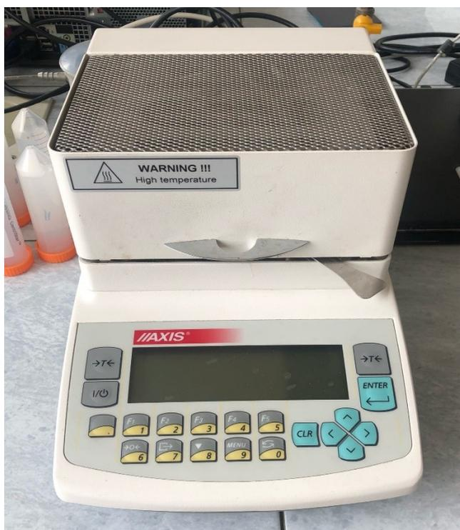
Рис.5. Электронный сушильно-гравиметрический анализатор влажности
