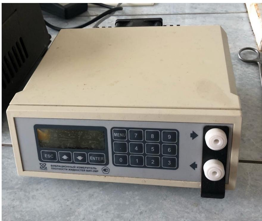
Рис.2. Вибрационный измеритель плотности жидкости
