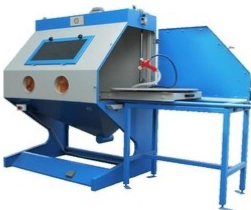
Рисунок1. Эжекторная абразивно-струйная камера VM3 KCO-110-I-SF-V
