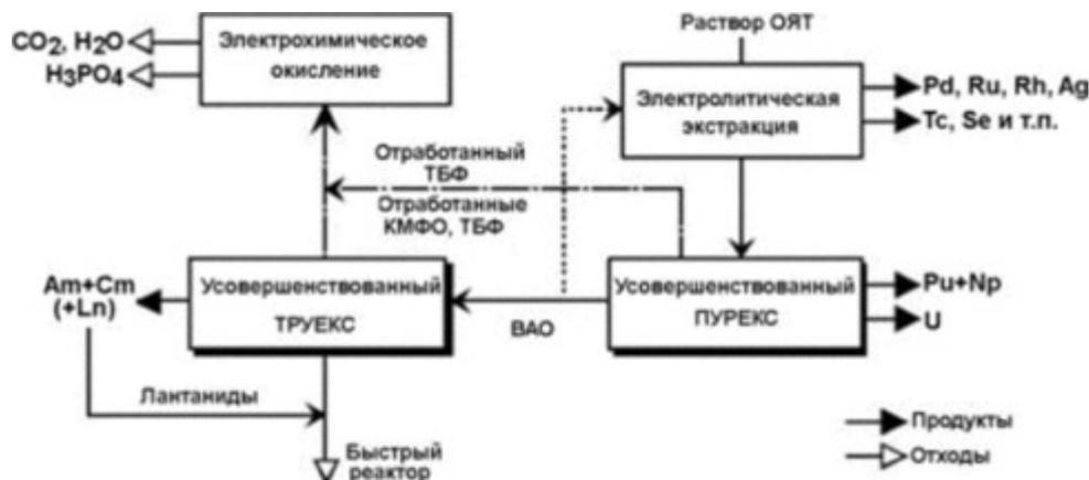
Рис. 5. Схема пурекс-труекс интегрированной системы разделения.
