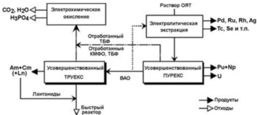
Рис. 5. Схема пурекс-труекс интегрированной системы разделения.
