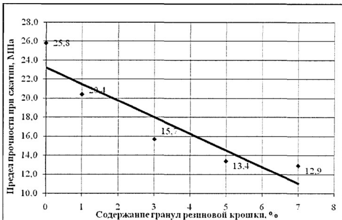
Рисунок 10 - Зависимость прочности при сжатии мелкозернистого цементобетона от содержания гранул резиновой крошки
