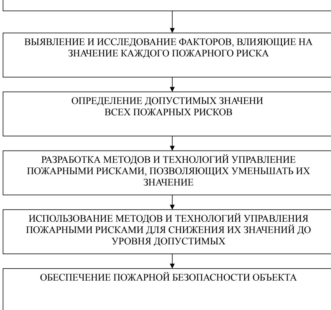
Рис .1 Алгоритм обеспечения пожарной безопасности объекта защиты
