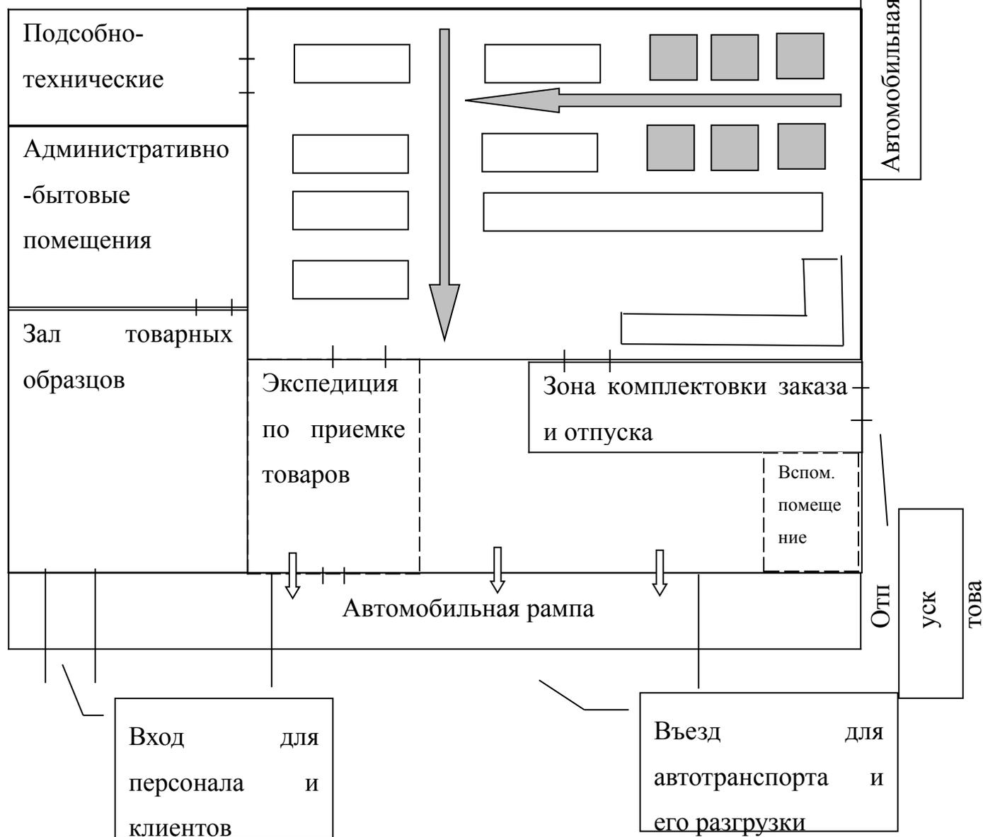
Рис. 2.5 Технологическая планировка склада
