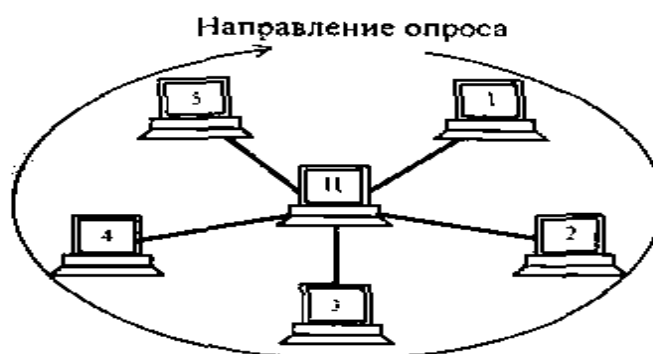
Рисунок 1 - Метод управления обменом в сети с топологией «звезда»
