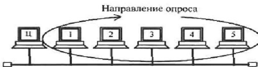
Рисунок 2 - Метод управления обменом в сети с топологией «шина»
