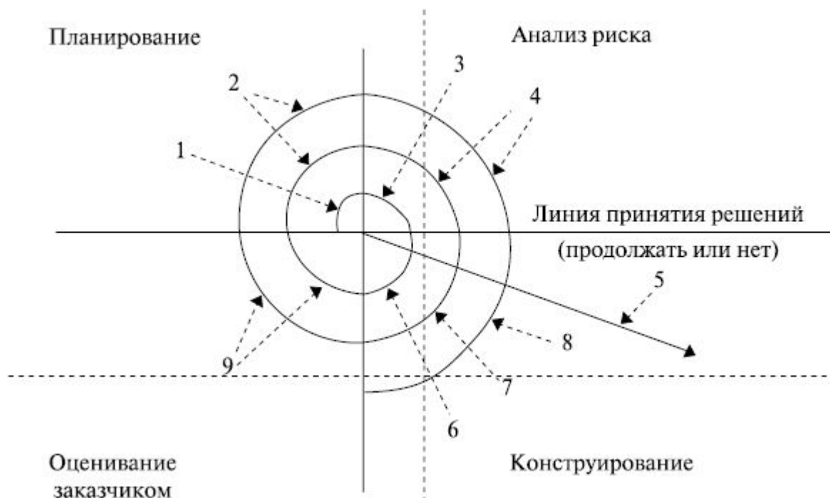
Рисунок 4 - Схема спиральной модели жизненного цикла разработки ПО
