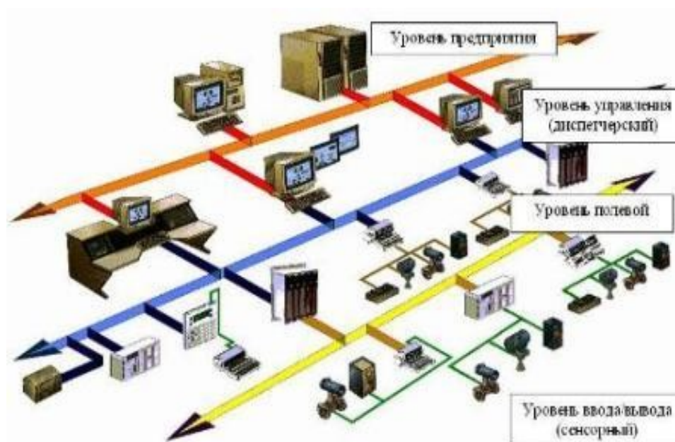
Рис.4.1. Структура комплекса технических средств АСУ ТП
