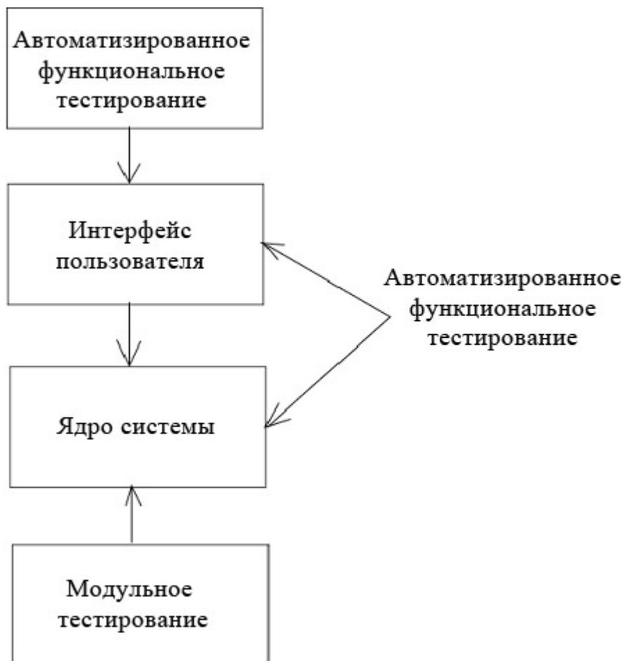
Рисунок 3 – Схема одновременного использования автоматизированного тестирования по сценариям пользователя и модульного тестирования МП
