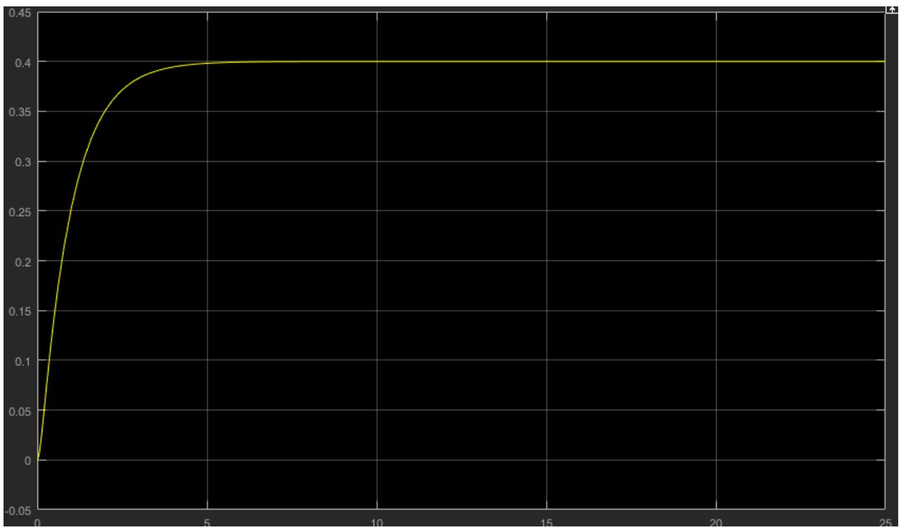
*Рис.8. Переходная характеристика объекта управления*
