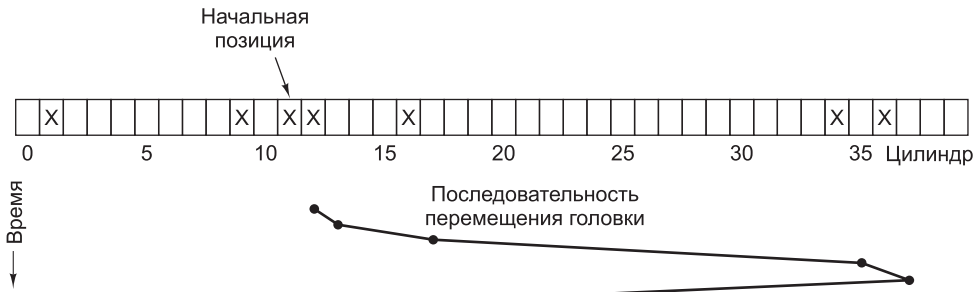
Рис. 5.21. Алгоритм лифта для планирования обслуживания дисковых запросов
