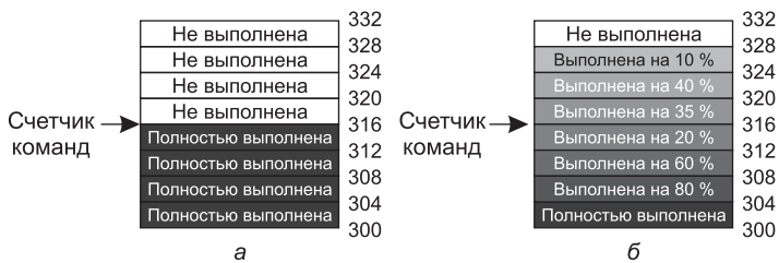
Рис. 5.5. Прерывание: а — точное; б — неточное
