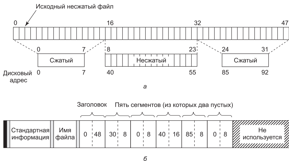
Рис. 11.28. а — пример сжатия файла из 48 блоков до размера в 32 блока; б — запись MFT для файла после сжатия
