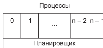
Рис. 2.3. Самый низший уровень структурированной в виде процессов операционной системы обрабатывает прерывания и планирует выполнение процессов. Выше этого уровня находятся последовательные процессы
