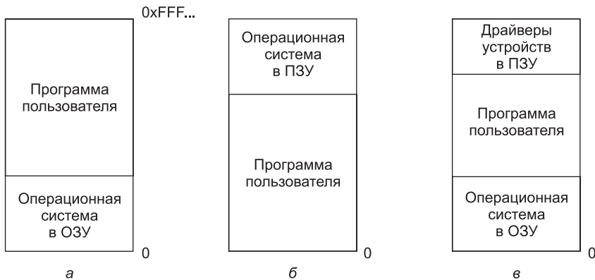
Рис. 3. 1. Три простых способа организации памяти при наличии операционной системы и одного пользовательского процесса (существуют и другие варианты). При таком устройстве системы памяти процессы, как правило, могут запускаться только по одному. Как только пользователь наберет команду, операционная система копирует запрошенную программу с диска в память, после чего выполняет эту программу. Когда процесс завершает свою работу, операционная система отображает символ приглашения и ожидает ввода новой команды. По получении команды она загружает в память новую программу, записывая ее поверх первой программы
