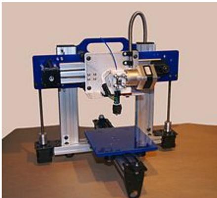
**3D-принтер** — станок с числовым программным управлением, использующий метод послойного создания детали.
