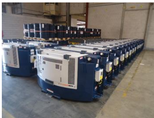
Рисунок 2.1 – Навесной дизельгенератор (Дженсет)
