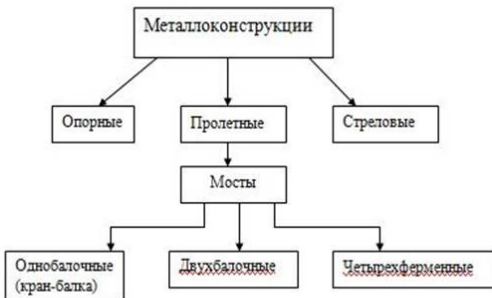
Рисунок 2.1- Виды металлоконструкций кранов
