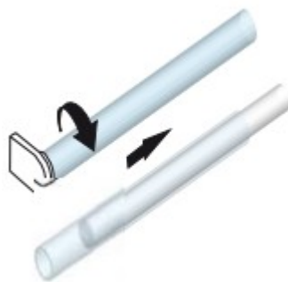
Рисунок 9 – Замена лампы в холодильной витрине
