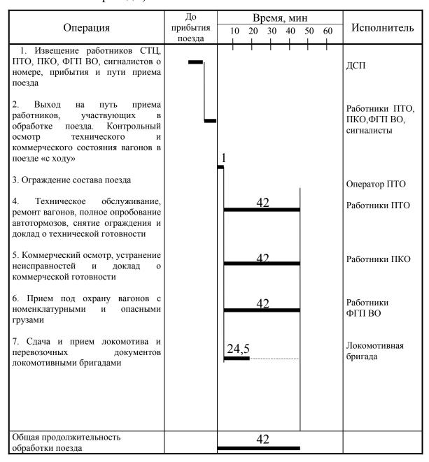
Таблица 5.3 График обработки транзитного без переработки поезда без изменения веса и длины со сменой локомотива
