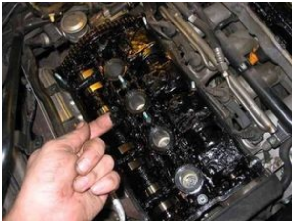
Рисунок 7. Отложения в двигателе.
