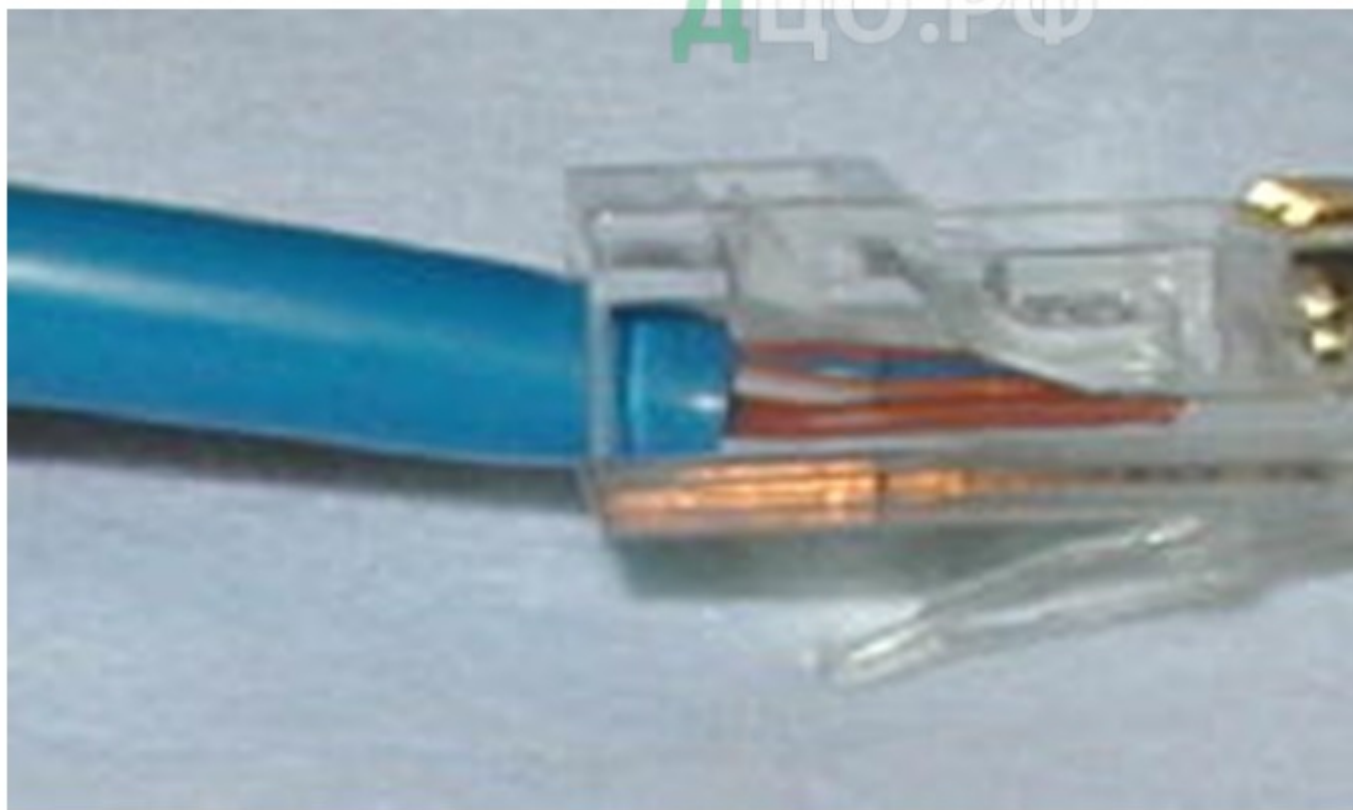
Рисунок 15 — Неправильная обжимка «витой пары»
