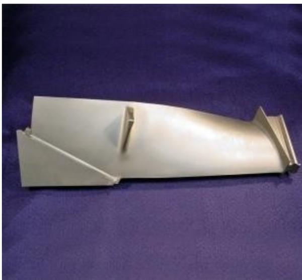
Рисунок 1.12. Лопатка из сплава Ti6Al4V с приваренной вставкой электронно-лучевым методом (Precision Technologies, Inc)
