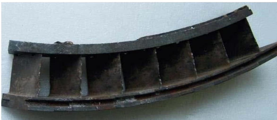
Рисунок 1.7. Деформация в виде забоин и вырывов материала соплового блока ГТУ ГТН25 [13].
