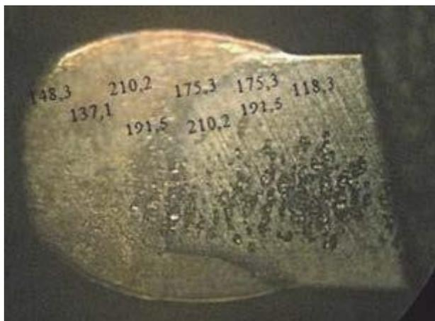
Рисунок 1.14. Поперечный макрошлиф торца пера лопатки [41].
