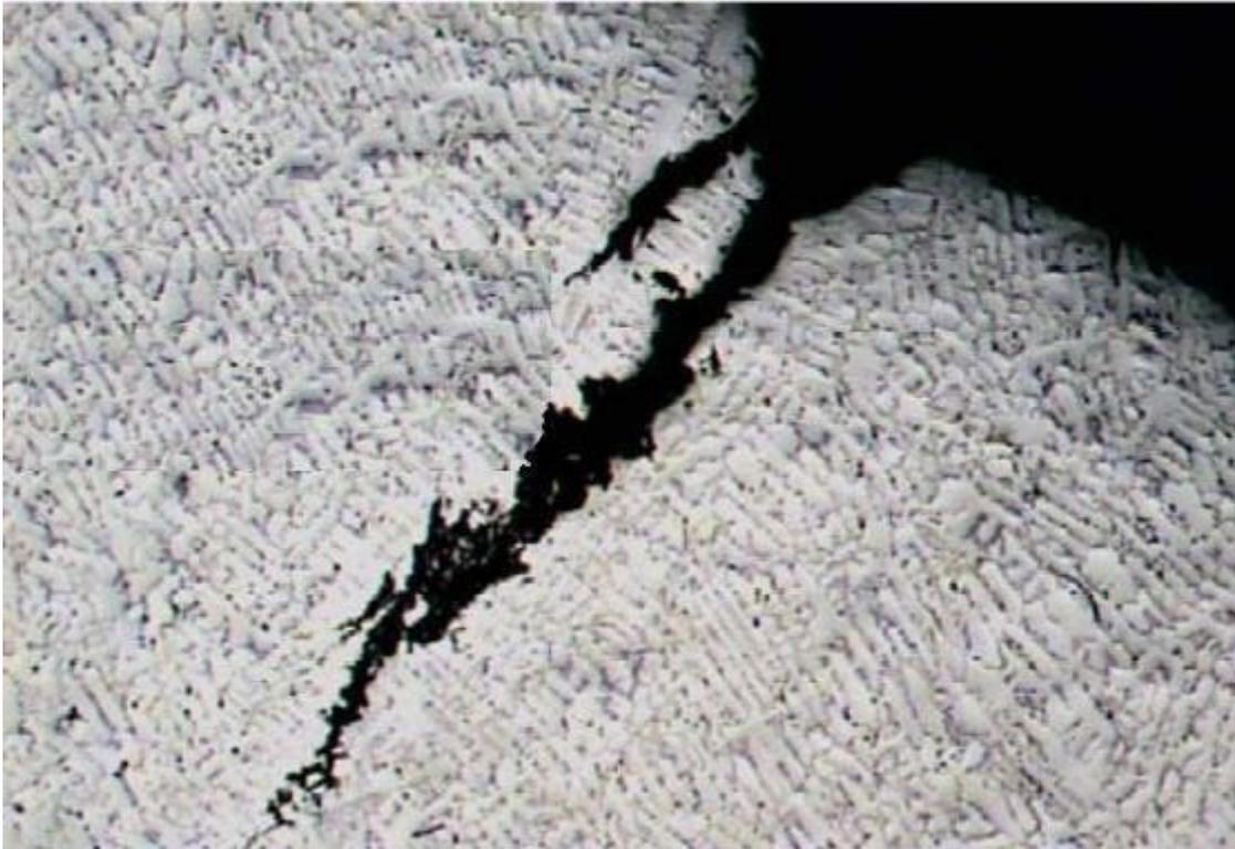
Рисунок 1.9. Очищенная трещина в сплаве на основе кобальта [23].
