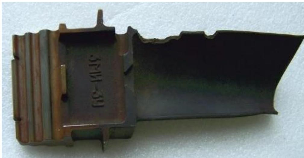
Рисунок 1.6. Местное выкрашивание лопатки ТВД ГТД ГТН 25 (наработка 32152 ч.) [13].
