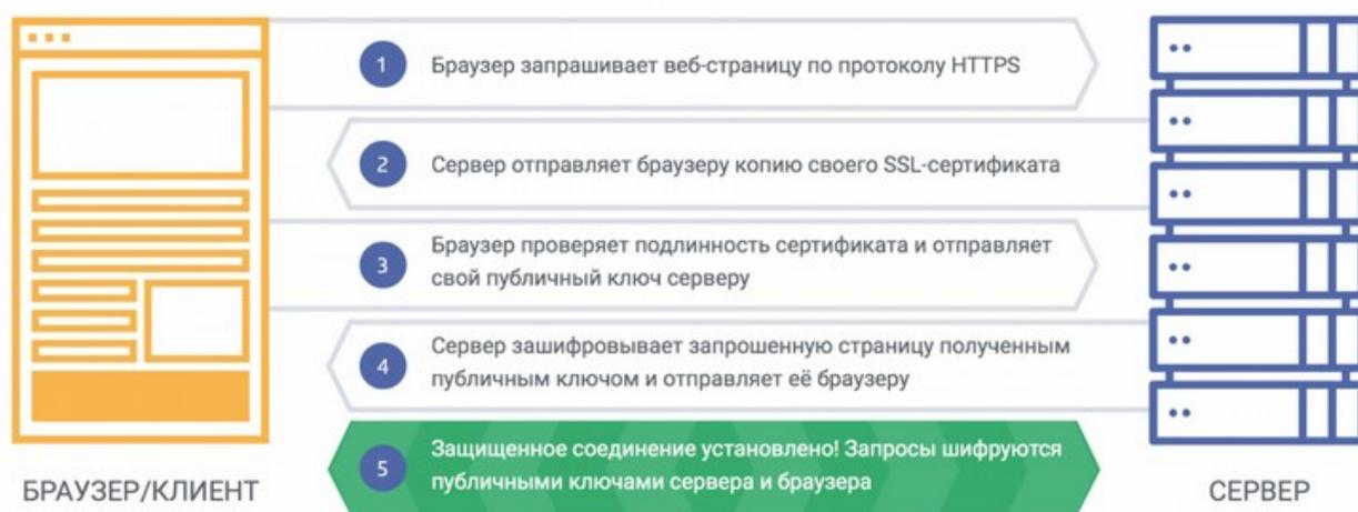
Рисунок 11 – Схема использования защищенного протокола
