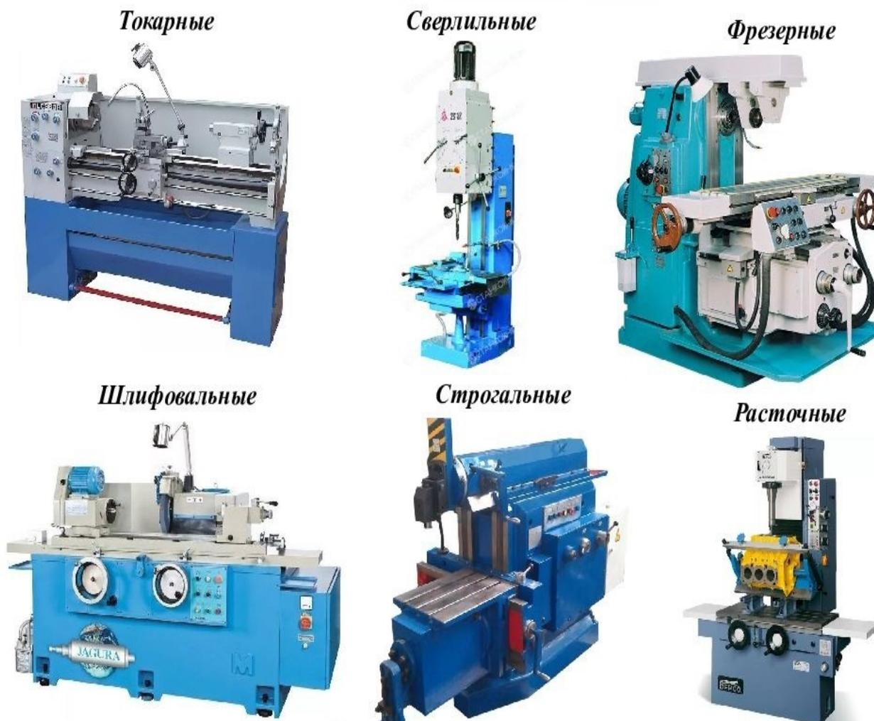
Виды металлорежущих станков.
