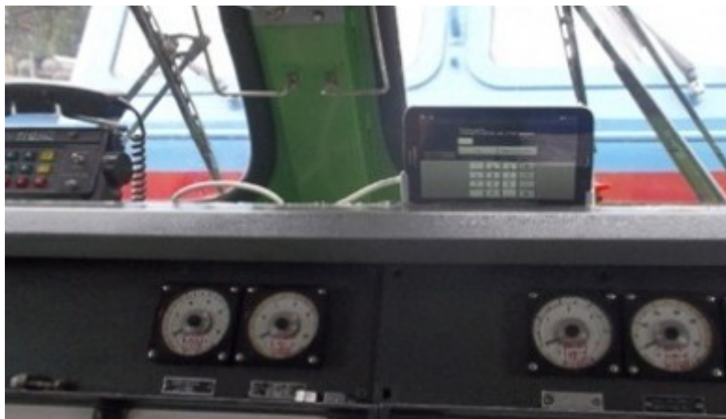
Рисунок 3 – Установленный Электронный машинист
