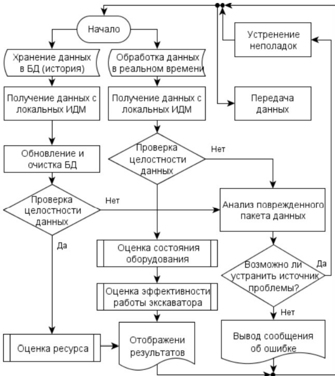
Рисунок 13 – Блок-схема работы системы «Электронный машинист»
