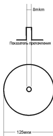
Рисунок 2.4 – Ступенчатое одномодовое волокно.
