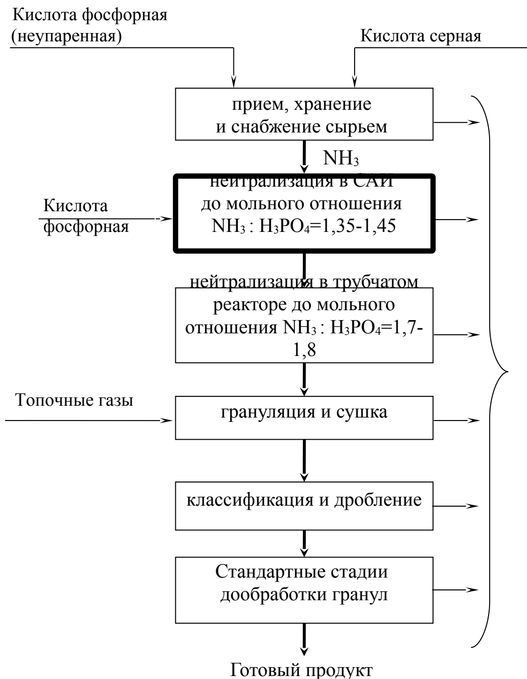
Рисунок 2 – Стадии получение гранулированного диаммонийфосфата
