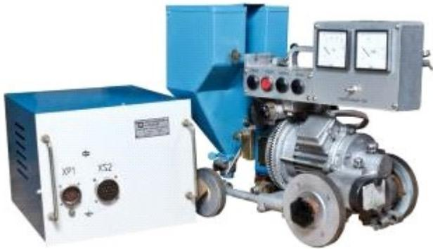
Рисунок 6 - Сварочный трактор АДФ-1002
