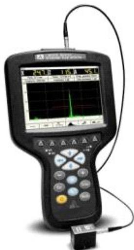
Рисунок 7 - Ультразвуковой дефектоскоп А1212 МАСТЕР.
