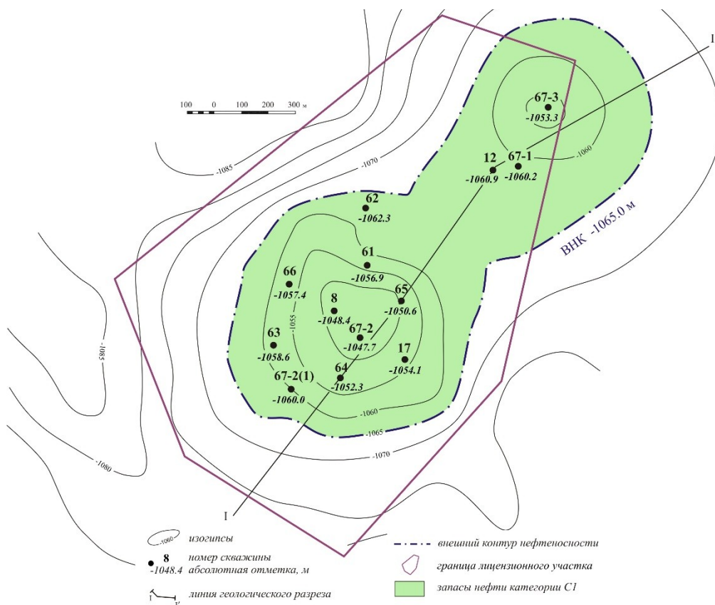
Рисунок 5 - Структурная карта кровли продуктивного пласта А4
